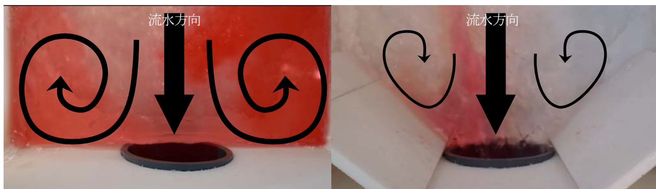
写真1 ウイング角度による呑口周辺に発生する渦流の違い (左：ウイング角度 0° 渦流が大きい、右：ウイング角度 40° 渦流が小さい)
