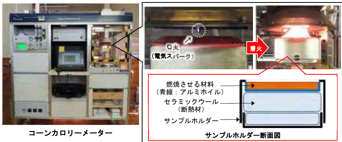
図1 コーンカロリメーターの概要
