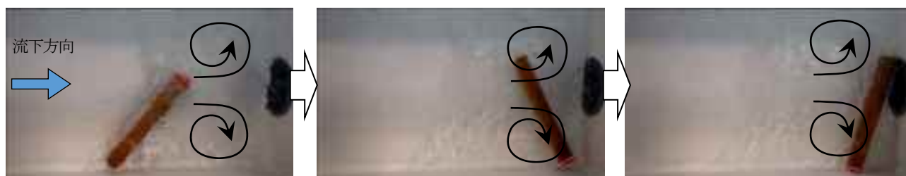
写真1 ウイング角度による吞口周辺に発生する渦流の違い (左：ウイング角度 0° 渦流が大きい、右：ウイング角度 40° 渦流が小さい)
