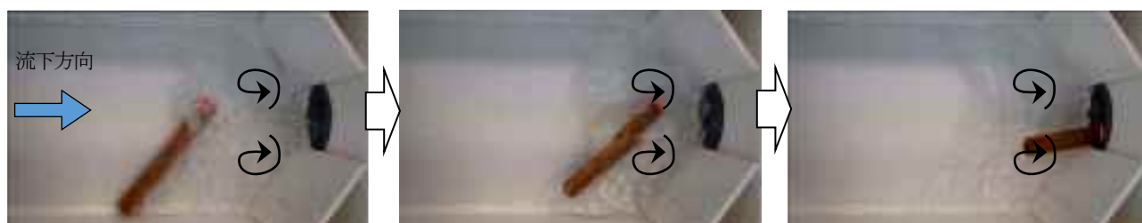
写真b) ウイング角度 40° : 吞口周囲の渦流（写真中の黒矢印）は小さく、丸棒はスムーズに流下する
